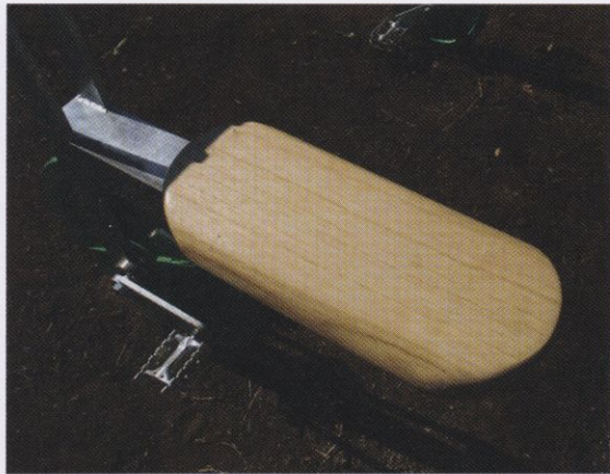
サドルの桐材は塗装仕上げ
